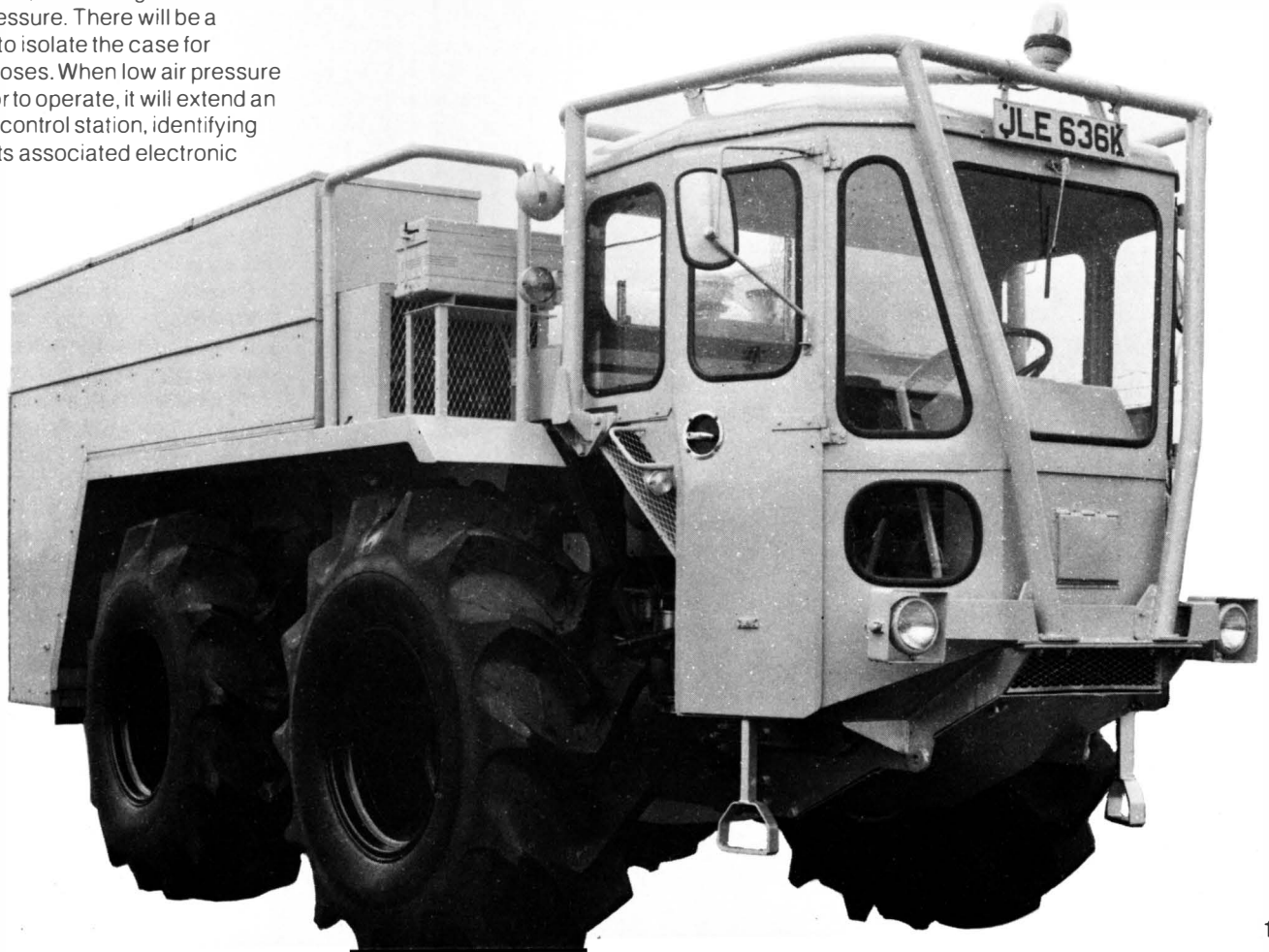
Cable winch unit
