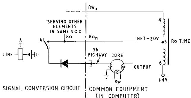
FIG. 8—TYPICAL S.C.C. TO E.C.E. IN-COMPUTER HIGHWAY
