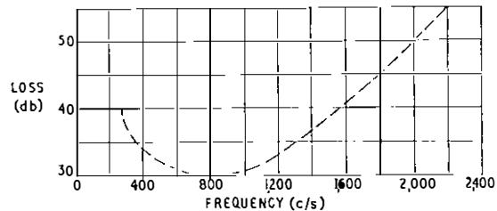
FIG. 1—LOSS/FREQUENCY CHARACTERISTIC OF NOMINAL EXTREME CONNEXION
