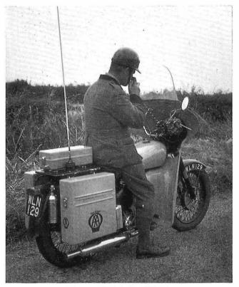
FIG. 2-MOBILE RADIO STATION
