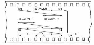
FIG. 2—AUTOSCOPE SCANNING SEQUENCE SHOWING LONGER STEP BETWEEN NEGATIVES
