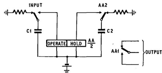
FIG. 6.—BASIC CORRECTOR CIRCUIT.
