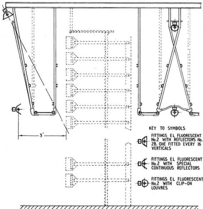
FIG. 6.—FLUORESCENT LIGHTING FOR PARALLEL M.D.F.'S WITH MEZZANINE PLATFORMS. (TO SIMPLIFY THE DIAGRAM THE RIGHT-HAND FRAME HAS BEEN OMITTED.)
