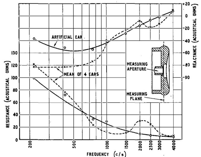
FIG. 2.—ACOUSTICAL IMPEDANCE OF REAL AND ARTIFICIAL EARS.
