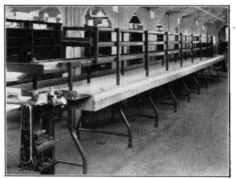
FIG. 5.—TUBULAR STEEL FACING-TABLE.
