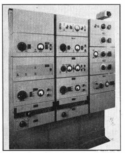
FIG. 6.—EARLY SHORT-WAVE SINGLE-SIDEBAND RECEIVER.
