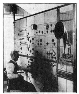
FIG. 4.—LONG-WAVE TELEPHONY RECEIVER AT CUPAR RADIO STATION.
