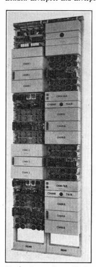
FIG. 5.—CARRIER SYSTEM NO. 5.— CHANNEL EQUIPMENT.
