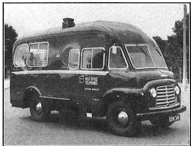
FIG. 3.—THE NEW CABLE TEST VAN.
