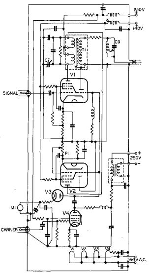
FIG. 5.—FREQUENCY CHANGER CIRCUIT.
