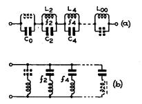
FIG. 1.--STANDARD FORMS FOR REACTANCE CIRCUITS.
