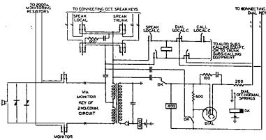
FIG. 6.—OPERATOR'S CIRCUIT.
