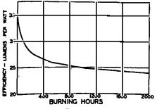
FIG. 5.-TYPICAL EFFICIENCY/LIFE CURVE.
