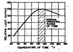
FIG. 6.—GRAPH ILLUSTRATING EFFECT OF TUBE TEMPERATURE ON EFFICIENCY.
