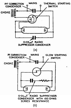
FIG. 4.—TYPICAL LAMP OPERATING CIRCUITS.
